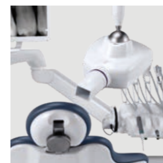
RXDC – tecnologia HyperSphere Integrato al riunito, radiografico e palmare non richiedono altri punti d'installazione. Ottimo parallelismo grazie alla collimazione di 30 cm associato al fuoco da 0,4 mm, garantisce immagini eccellenti. Toccando le zone touch-sensitive, la testata si sblocca e ruota liberamente attorno al giunto sferico.
