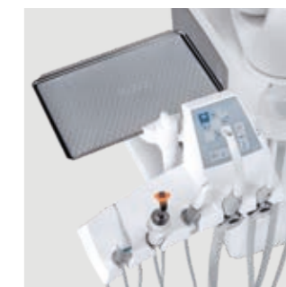
Tavoletta assistente Tavoletta, con display touch, che beneficia di un'escursione verticale notevole. Il doppio braccio articolato consente un posizionamento idoneo ad ogni situazione clinica. Disponibile con 3 o 5 alloggiamenti, nella versione maggiorata opzionale, il medico può disporre di telecamera, lampada polimerizzante e siringa abbinata alle due cannule.
